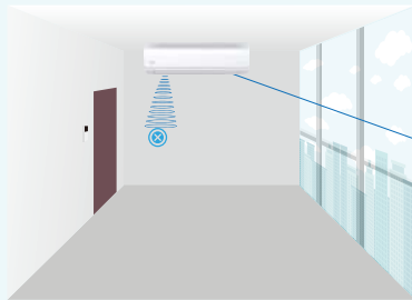
La unidad interior se detiene automáticamente al detectar que no hay personas
